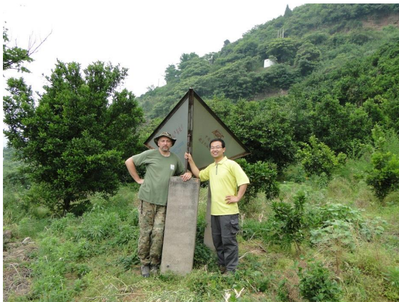
Rys.11. Reflektory trójkątne stosowane na osuwisku Shuping (fot. T. Wojciechowski)
