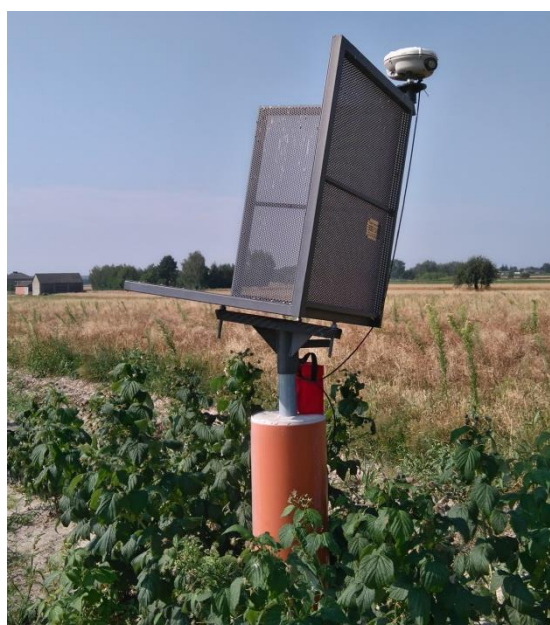
Rys. 16. Reflektor dla pomiarów sygnałów z satelity TerraSAR-X (poligon Berejów). Fot. Autor
