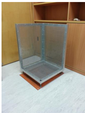
Rys. 10. Prototyp reflektora stosowanego w Hong Kongu (Qin et al. 2013)
