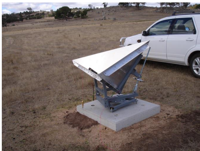
Rys. 12. Reflektory sieci geodezyjnej Australii (Garthwaite et al. 2015).
