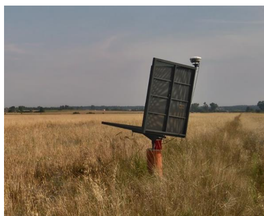
Rys. 17. Reflektor dla pomiarów sygnałów z satelity Sentinel-1 (poligon Berejów). Fot. Autor
