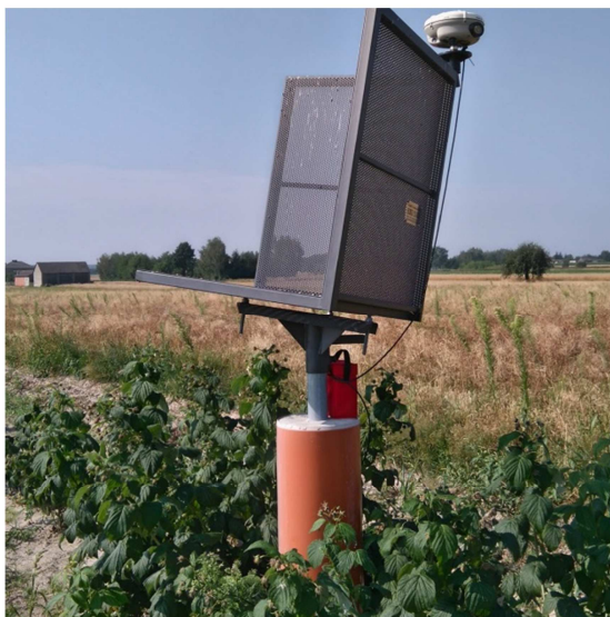
Rys. 5. Reflektor dla pomiarów sygnałów z satelity TerraSAR-X (poligon Berejów). Fot. Autor
