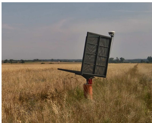
Rys. 6. Reflektor dla pomiarów sygnałów z satelity Sentinel-1 (poligon Berejów). Fot. Autor
